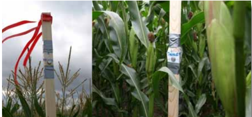
Temperaturloggrarna var monterade vid vippans respektive vid kolvarnas höjd i majsältet. Temperaturen mättes en gång i timmen under 8 veckor.
