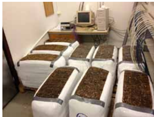
Temperaturmätning i småbalar vid 20°C rums-temperatur.
