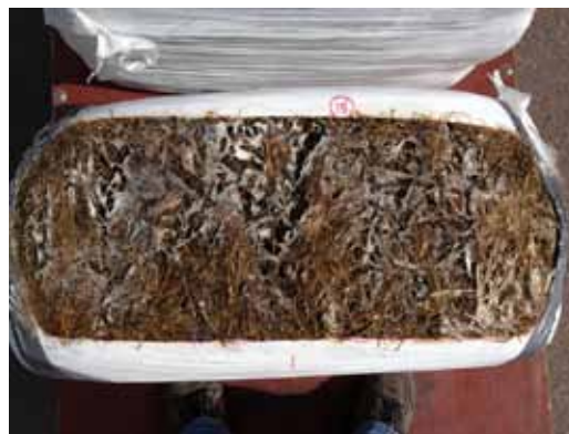
Behandlad bal efter fem dagar med sprucken klisteryta.
