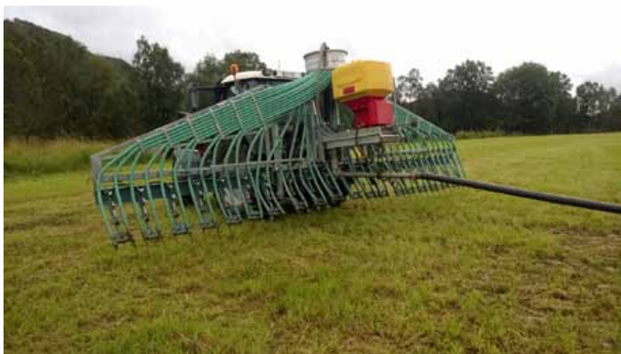
Figur 1. Stallgödselspridare med aggregat för flytgödselsådd av vallfrö från Agromiljø AS. Maskinen på bilden är en prototyp med harvpinnar som bearbetar vallsvålen lätt i samband med utmatningen. Gödseln pumpas till spridaren från lager eller tankvagn utanför fältet genom en slang.
