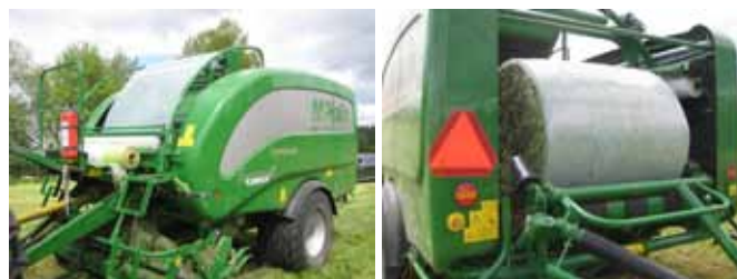
Rundbalspress McHale Fusion 3 utrustad för mantelfilm. Det är viktigt att mantelfilmen täcker kanten på balen så att formen blir jämn. Foto: Rainer Nylund.
