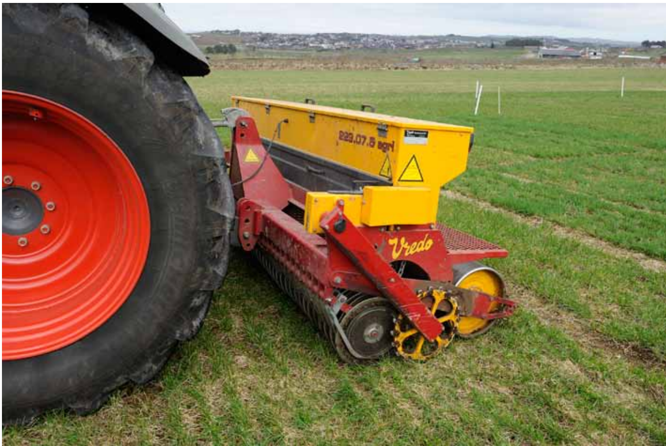
Bild 1. Vredo specialmaskin för direktsådd av vallfrö.
