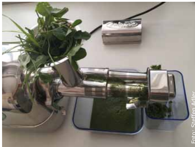
Figur 2. Denna skruvpress i laboratorieformat används i projektet. Den ger liknande resultat som en storskalig kommersiell maskin.
