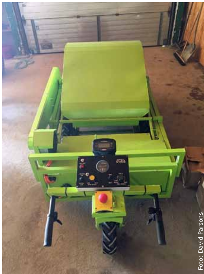
Figur 3. Denna eldrivna prototyp av 'MRFE' bladrepningsmaskin har tillverkats av TRUST'ING i Frankrike. Den har tagits fram speciellt för användning i småskaliga fältförsök. Bladmaterialet samlas in en behållare fram till på maskinen. En storskalig bladrepningsmaskin kommer snart ut på marknaden.
