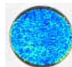
Figur 5. Exempel på hyperspektral bild av ett malet betesprov. Variationen i pixlar visar variationen i provets innehåll.
