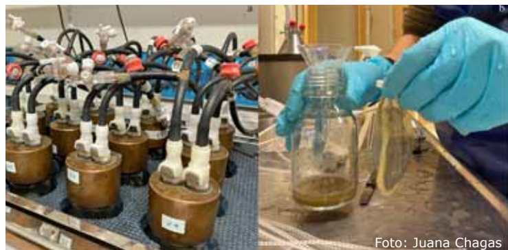
Figur 2. Utvärdering av foders näringsvärde på lab: a. in vitro gasproduktions-teknik för att mäta mängden metan som bildas i våmmiljön b. Analys av den organiska substansens verkliga smältbarhet.
