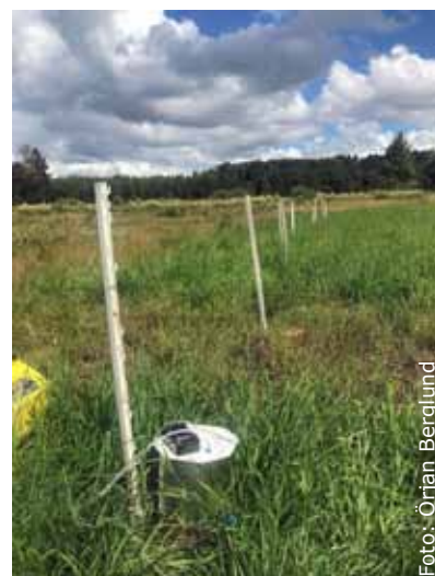
Figur 2. Manuell mätning av växthusgaser i mörk kammare. Kammaren placeras på en ram nedslagen ca 5 cm i marken och luften i kammaren cirkuleras genom gas-sensorn för att mäta koncentrationsökningen av växthusgaserna under den ca 5 minuter långa mätningen.
