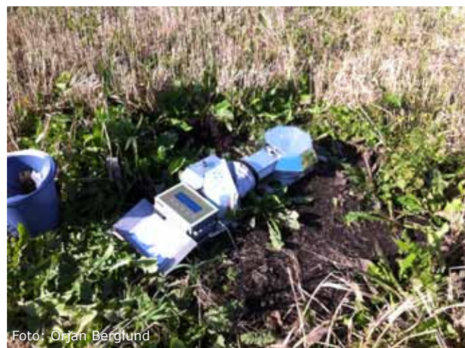
Figur 3. Automatisk mätning av koldioxid med en sensor från ADC. Samtidigt mäts fotosyntetiskt aktiv solstrålning, markfukt och marktemperatur. Det görs en mätning 8 ggr/dygn under den snöfria perioden.
