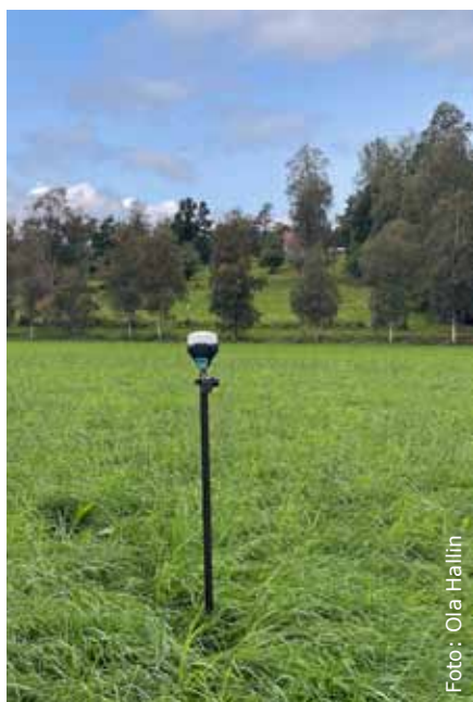
Figur 1. GPS med hög precision som används för att lokalisera mitten av en pixel.
